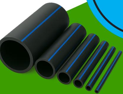
Os tubos PEAD BTFlex Água – rede de distribuição podem ser fabricados em PE 80 ou PE 100, nos diâmetros de 20 a 250 mm. Disponíveis em barras de 6 ou 12 metros (todos os diâmetros) ou em bobinas de 25, 50 ou 100 metros para diâmetros de até 110 mm. Podem ser fornecidos nas cores azul, preto com listras azuis ou preto com listras ocres.
